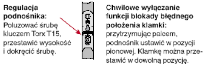
Rys. 3. Regulacja podnośnika
