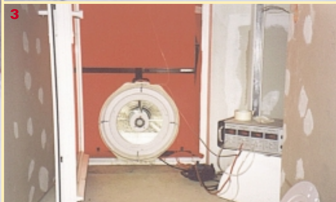
fot. 1 – Budowa domu pasywnego w Gdańsku Osowej fot. 2 – Ściana ocieplona 34 cm styropianem Termo-Lambda. Drzwi ciepłochronne firmy Bertrand fot. 3 – Test szczelności budynku pasywnego – tzw. „blower door test” fot. 4 – Przekrój ramy i skrzydła okna Bertrand S 7000 IQ PASSIV
